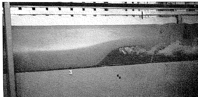
d/ Action d'un courant de turbidité à très forte concentration sur des dépôts de vase peu consolidée (le dépôt est soulevé par le courant de turbidité) Effect of a very highly concentrated density current on a relatively unconsolidated mud deposit, which it lifts up
