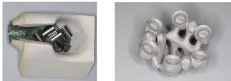
Figs. 6.9 y 6.10. Material en el cono refractario y estructuras coladas.
