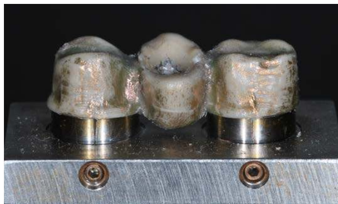
Fig. 7.25. Fractura de la probeta P4.
