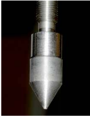
Figs. 6.78 y 6.79. Detalle del empujador y empujador enroscado en máquina de ensayo.
