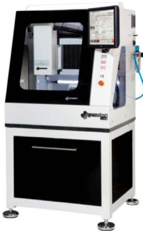
Fig. 6.45. Fresadora Yenadent D43, utilizada para mecanizar las estructuras de PEEK.
