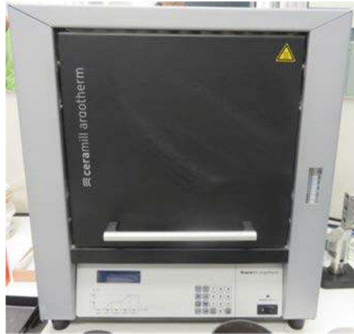
Figs. 6.25 y 6.26. Detalle de la bandeja de sinterización del Argovent y cilindro e imagen del horno de sinterización Ceramill® Algothem 2.
