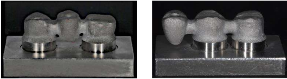
Figs. 6.18 y 6.19. Estructura de Co-Cr fabricada mediante sinterizado láser con pónico intermedio y con pónico en cantilever.
