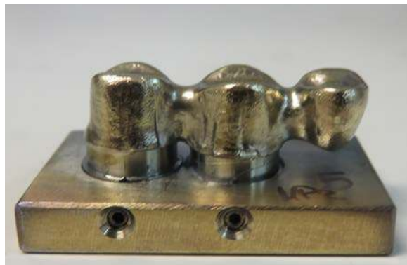
Fig. 6.57. Probeta MPC 5 metalizada y lista para ser medida con microscopía electrónica.
