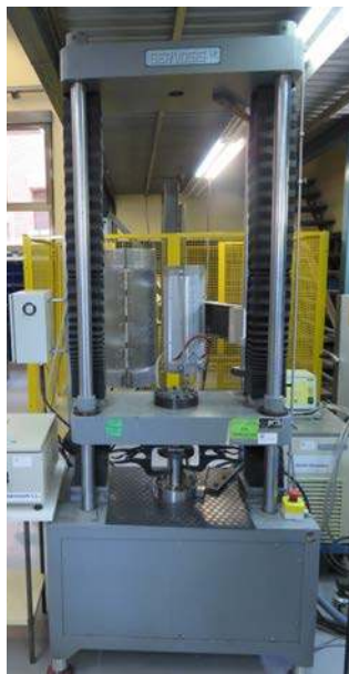
Figs. 6.81 y 6.82. Vista frontal del cuerpo de la máquina de ensayo y detalle de la célula de carga y mordazas para sujetar la pletina donde se alojan las probetas.
