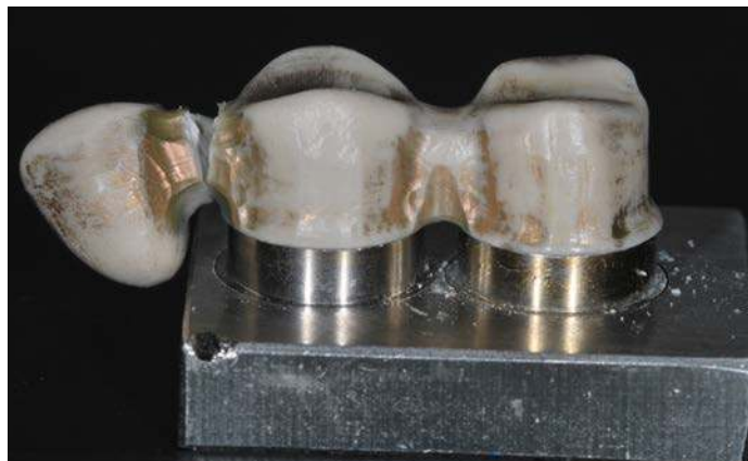
Fig. 7.39. Fractura de la probeta P3.
