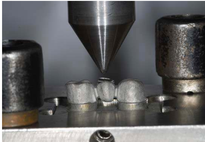
Fig. 6.84. Lámina de estaño posicionada sobre probeta MP2 preparada para ser cargada.
