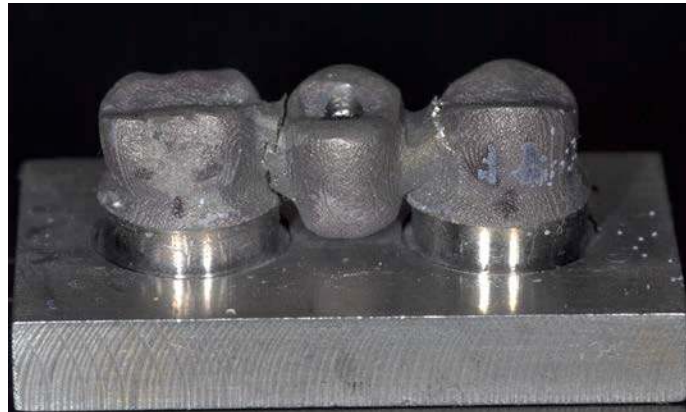
Fig. 7.21. Fractura de la probeta MS4.
