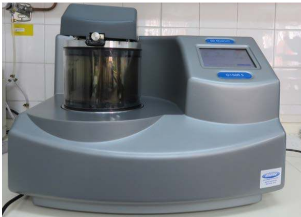
Figs. 6.55 y 6.56. Metalizadora Quorum Q150R S y probetas posicionadas tras metalización.
