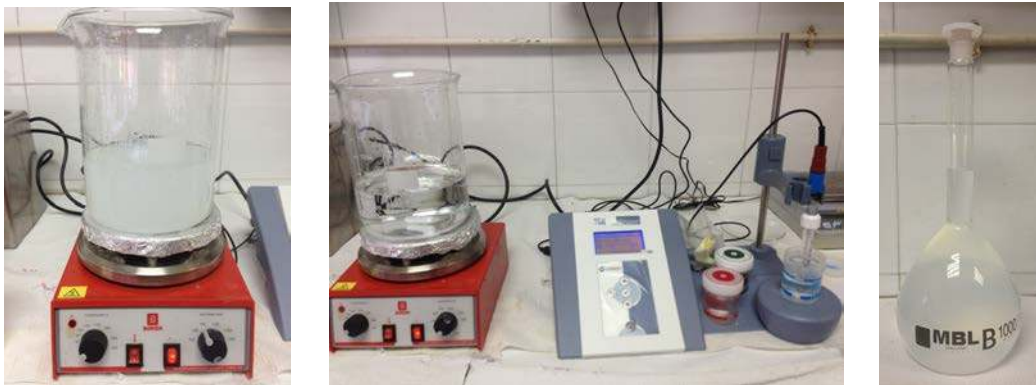
Figs. 6.73, 6.74 y 6.75. Fabricación de la saliva artificial, control con pH-metro y saliva artificial almacenada en probeta de ensayo.
