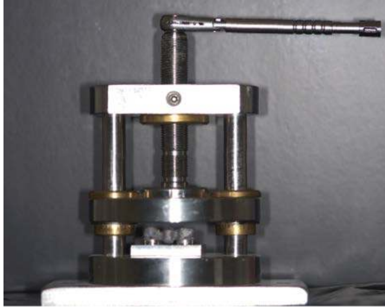
Fig. 6.52. Prensa de cementado controlada por llave dinamométrica.
