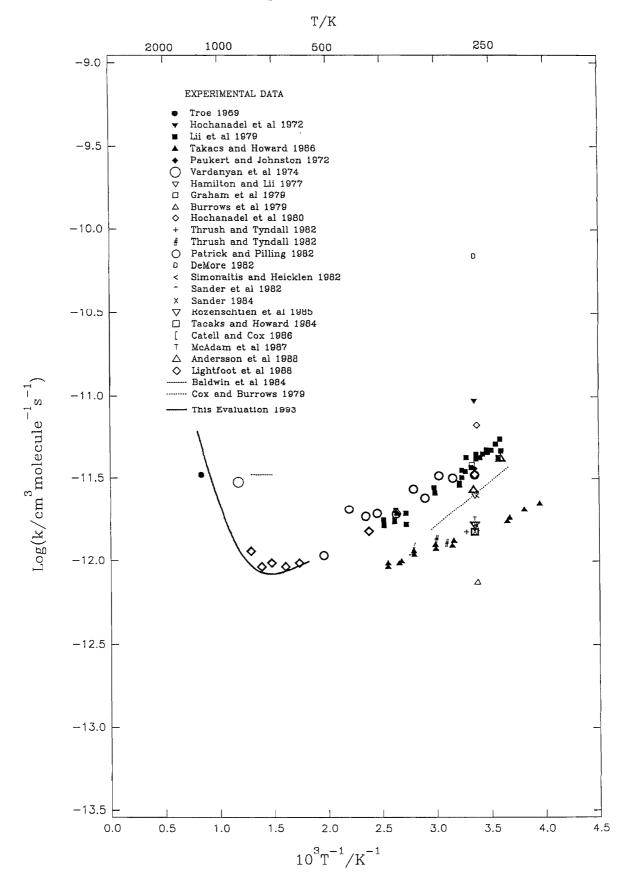
$$\begin{array}{c} HO_2 + CH_3O_2 \rightarrow CH_3OOH + O_2 & (1) \\ \rightarrow HCHO + H_2O + O_2 & (2) \end{array}$$
