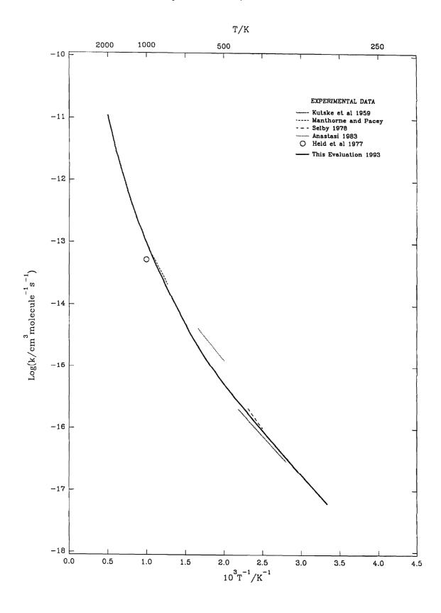
$$CH_3 + C_2H_5 (+ M) \rightarrow C_3H_8 (+ M)$$
