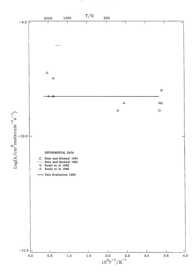
$$\begin{array}{cccc} C_2H_3 + O_2 \rightarrow C_2H_2 + HO_2 & (1) \\ \rightarrow H_2CO + CHO & (2) \\ \rightarrow C_2H_3O + O & (3) \\ \rightarrow C_2H_3O_2 & (4) \end{array}$$
