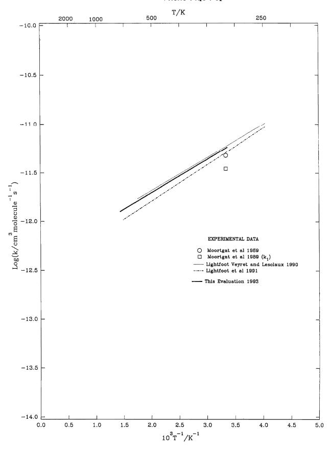
$$\begin{array}{c} HO_2 + C_6H_5CH_3 \rightarrow H_2O_2 + C_6H_5CH_2 \\ \rightarrow H_2O_2 + C_6H_4CH_3 \end{array} \hspace{0.5cm} \mbox{(1)}$$
