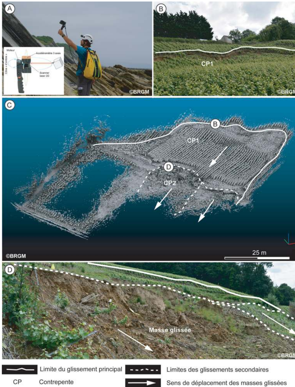
Fig. 7. Exemple de nuage de points obtenu par ZEB-Revo (scan laser terrestre 3D rotatif léger) pour un glissement de terrain de type rotationnel dans les vignes de Champagne (Commune de Le Mesnil-le Huttier-2018). A. Principes de fonctionnement du Zeb-Revo (lever sur la falaise de Socoa-Pyrénées Atlantique, France). B. Vue sur l'escarpement principal du glissement de terrain. C. Nuage de points et interprétation. D. Vue sur les glissements rotationnels secondaires.
