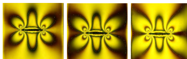
Рис. 8. Результаты цифровой обработки экспериментальной информации (скелетоны изохроматических полос) и точки, используемые для вычисления параметров механики разрушения (внизу)
