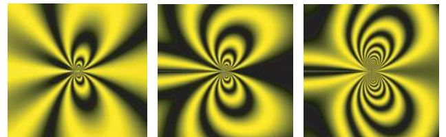
Рис. 9. Теоретически реконструированная картина изохроматических полос в пластине у правой вершины трещины
