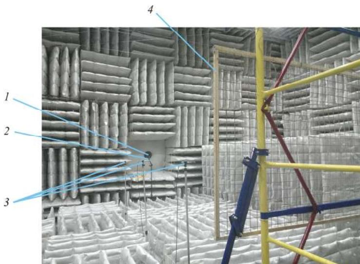
Рис. 3. Фотография системы регистрации параметров: 1 – сопло генератора вихревых колец; 2 – триггерный микрофон (А); 3 – микрофоны в дальнем поле (№ 1–3); 4 – экран с шелковинками
