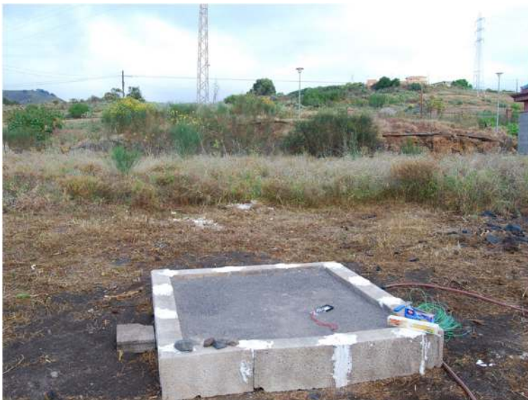
Fig. 1 Artificial crushed basalt sediment bed, prepared at Laboratorios de Calidad de la Construcción, Consejería de Obras Públicas, Gobierno de Canarias
