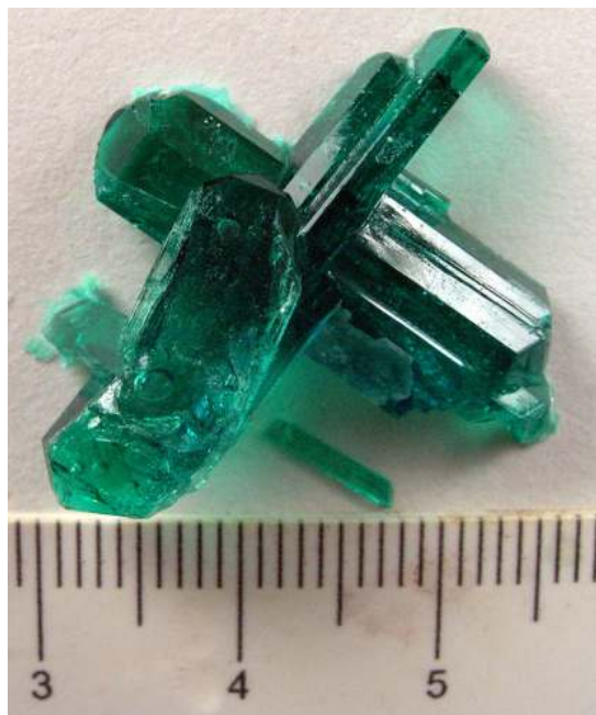
Figura 10. Cristais de sulfato de níquel hexahidratado, com forma prismática tetragonal, terminada em pirâmide.
