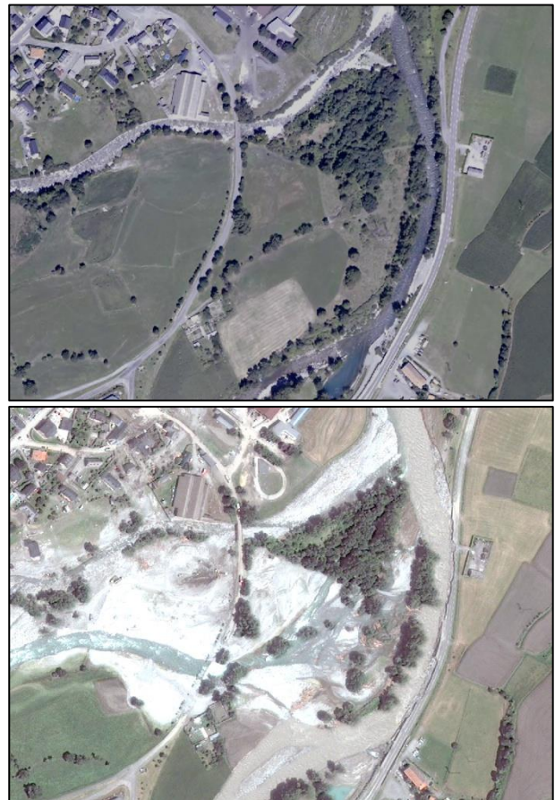
Figure 9: comparaison données de référence (Ortho Photo IGN) et image Pléiades post événement montrant la modification du cours des rivières et phénomènes érosifs importants au niveau des confluences Gaves de Pau et de Cauterets,
