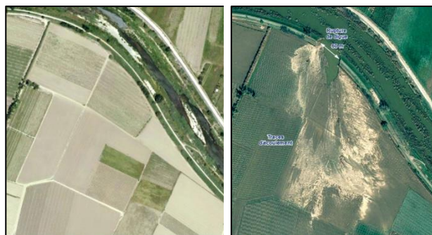
Figure 3: Exemple de dégâts aux structures, rupture de digues, inondation de l'Agly avec comparaison situation avant crise (Orthophoto IGN) et post crise (Pléiades)
