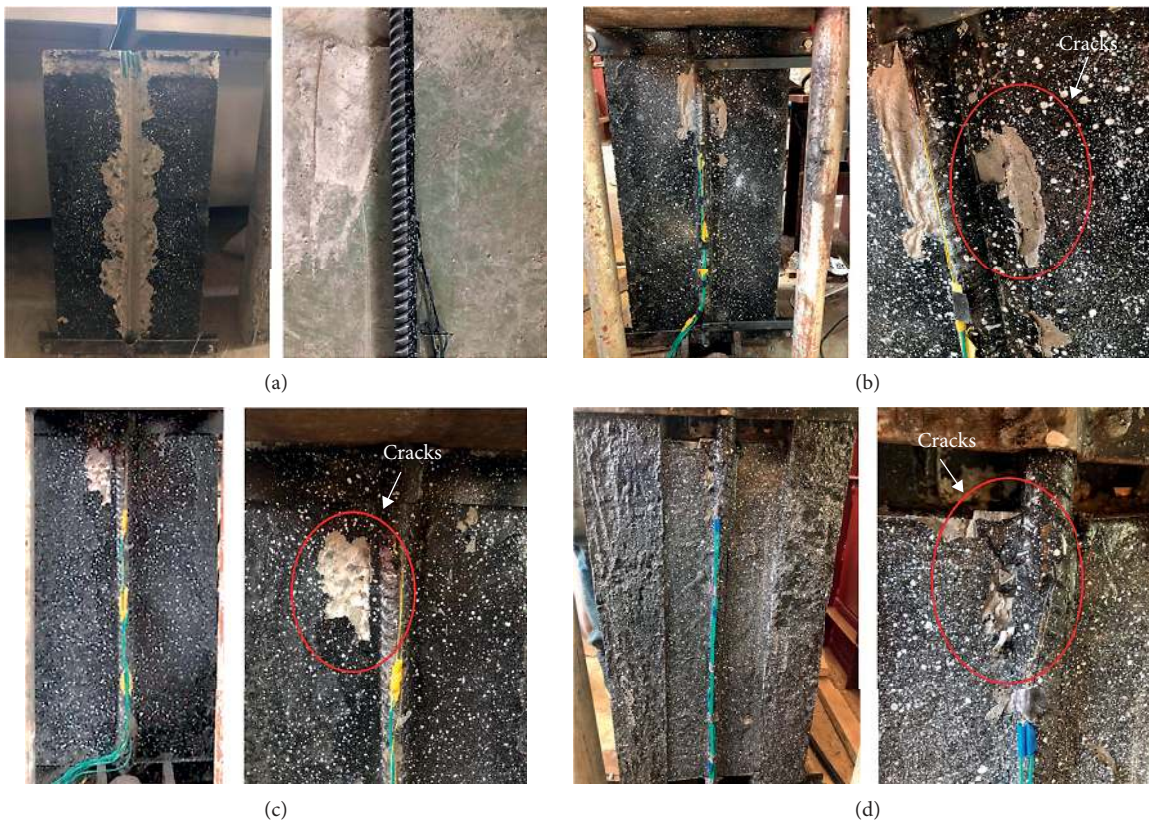
FIGURE 7: Specimen failure. (a) SJ-40. (b) SJ-50. (c) SJ-75. (d) SJ-160.
