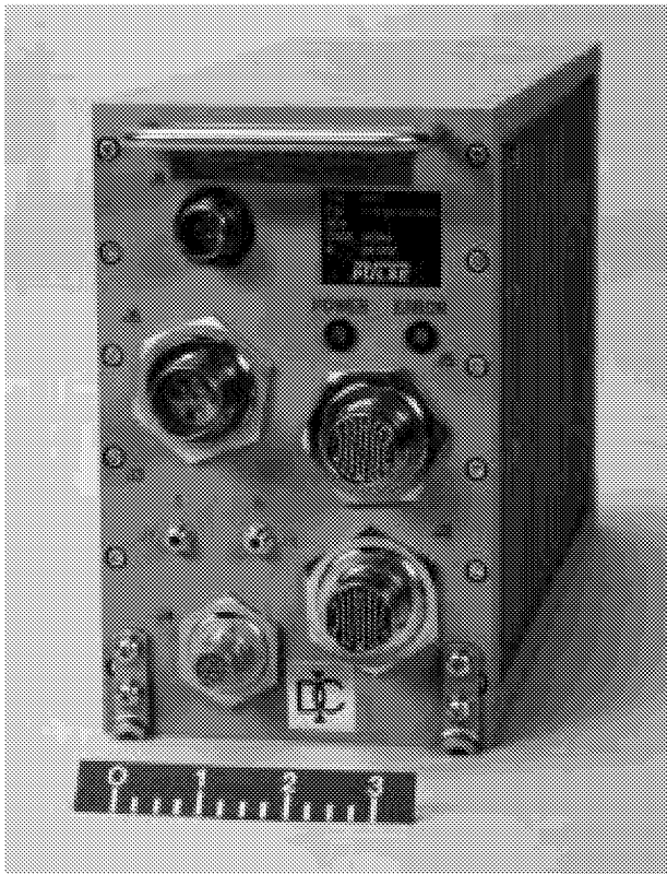
Figure 7. EPAD interface box (IBOX).
