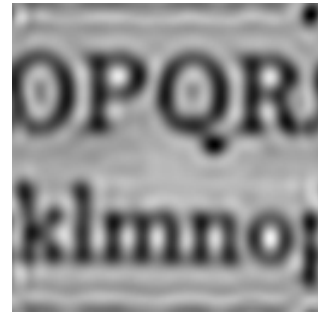
Restored using Actual PSF (Abel Transform)
