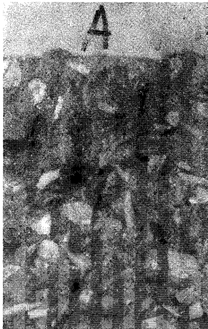
Fotos 2a y 2b.—La proporción árido grueso/mortero es menor en las probetas pequeñas que en las grandes.
