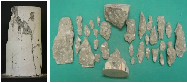
写真-2 破壊状況 (G20-W/C57)
