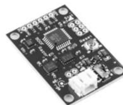
Rys. 1. Inercyjny układ pomiarowy Razor-IMU-9DOF[2]
