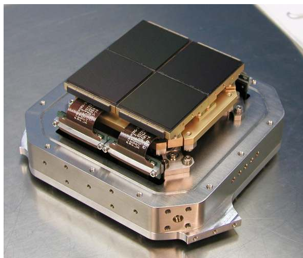
Fig. 8. HAWK-I detector mount.
