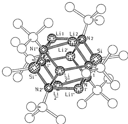
Abb. 7. Moleküldarstellung von **10** nach Röntgenstrukturanalyse. Die Kohlenstoffatome (offene Kugeln) sind nicht bezeichnet. Die Verbindungslinien bei  $Li-N$  stellen keine Zwei-Elektronen-Zwei-Zentren-Bindungen dar, sondern geben die kürzesten Abstände wieder [Punktsymmetrie:  $C_{2h}(2/m)$ ]
