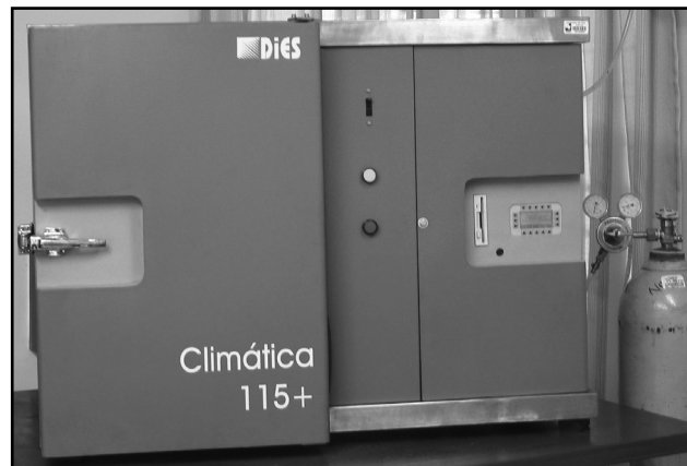
Figura 5. Cámara climática de CO 2 . Figure 5. Climatic chamber of CO 2 .
