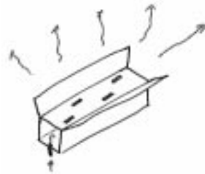
Figur 2.8. I en vågledarantenn förs antenssignalen in genom en kabel och utbreder sig i vågledaren. Genom att skära upp slit-sar på lämpliga ställen kan man få antenssignalen att stråla ut till omgivningen på ett bra sätt.
