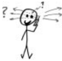
Figur 2.6. Mobiltelefonanvändare är i dubbel bemärkelse i vägen för telefonens radiosignaler. Dels kan sändarkvaliteten försämrans av att huvudet absorberar radiovågor, dessutom måste absorptionen hållas nere för att begränsa eventuella hälsorisker för användaren.
