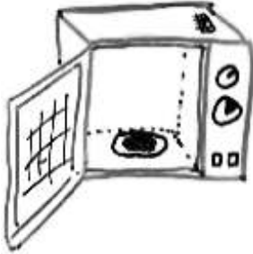
Figur 2.10. Mikrovågsugnar måste byggas så att man får en jämn fördelning av effekten i ugnen. Tinar man exempelvis mat vill man inte att ena halvan av maten blir överhettad medan andra halvan fortfarande är frusen.
