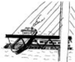
Figur 2.4. Om en båt med stark radar passerar ett tåg på en bro får inte tågets elektronik slås ut.
