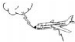
Figur 2.5. Det händer att blixten slår ner i flygplan och då måste flygelektroniken tåla de kraftiga störningar som uppstår.
