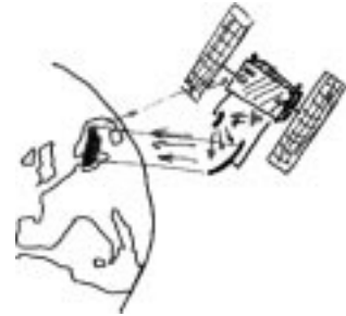
Figur 2.7. Man kan bygga mindre och lättare TV-satelliter om man kan buckla parabolantennerna så att sändningarna bara når de områden man vill täcka.
