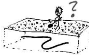
Figur 2.11. I många situationer känner man till vilka geometriska objekt som påverkar lösningen, och det är själva fältet man söker. Det finns dock en klass av problem där man känner lösningen, men inte geometrin. Dessa kallas inversa problem och ett exempel är när man mäter upp fältet ovanför en kabel, för att räkna ut var den ligger nergrävd.
