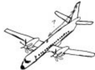
Figur 2.9. Antenner på flygplan måste placeras med omsorg så att de fungerar optimalt. De får exempelvis inte störa varandra.
