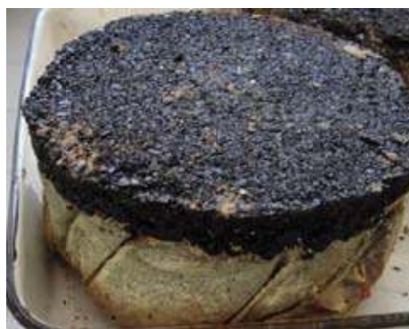
Рис. 5. Образец, содержащий криогель на основе ПВС и НПС
