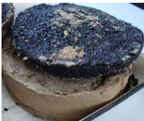
Рис. 4. Образец, содержащий криогель на основе ПВС
