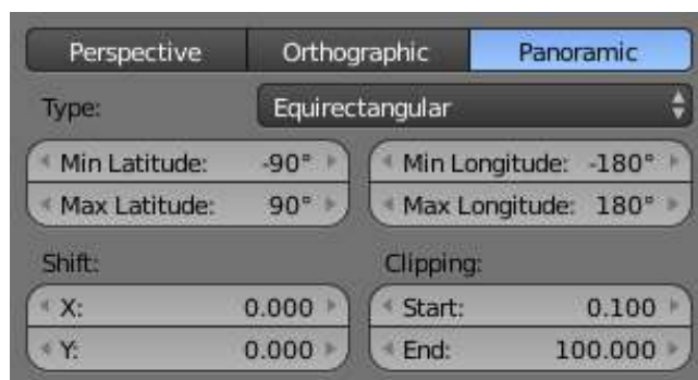
Рис. 1. Параметры виртуальной камеры 3D-редактора Blender, необходимые для рендеринга изображения в виде равнопромежуточной проекции
