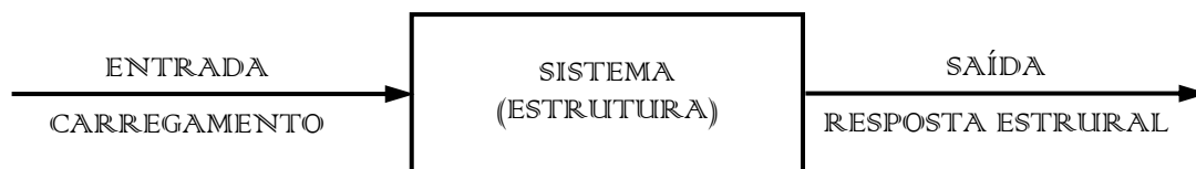
Figura 2.1: Relação excitação-resposta de um sistema estrutural
