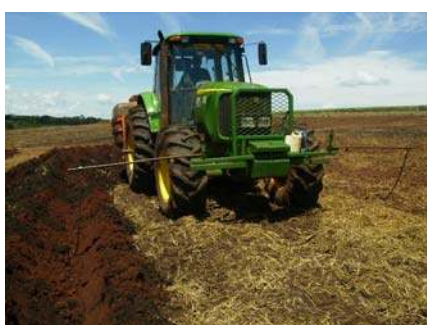
Figura 13 - Trator de sulcação com o dispositivo de orientação
