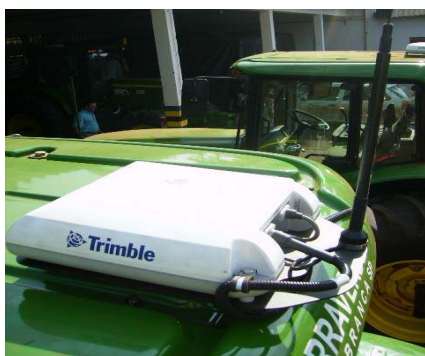
Figura 15 – Antena receptora de rádio e receptora do sinal GPS
