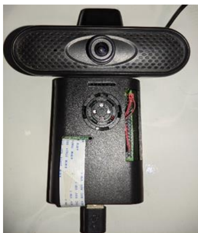
Gambar 7. Integrasi Kamera dan Modul Raspberry Pi 4
