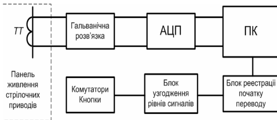
Рис. 2. Структурна схема системи діагностування та контролю стрілочних переводів
