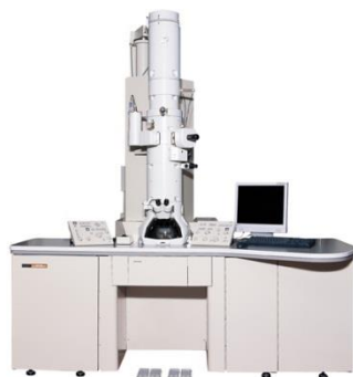
Figura 9. Microscopio analítico JEM 2010F equipado con detector HAADF
