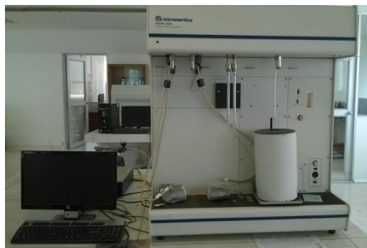
Figura 4. Micromeritics ASAP 2020 para determinación de superficie específica y dispersión metálica o adsorción química H/Me.
