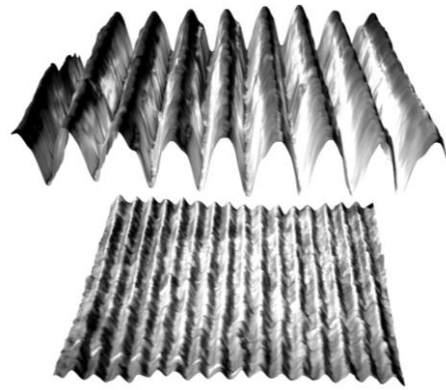
Рис. 3. Результаты моделирования и визуализация зазоров, образованных поверхностями втулки и полюсов разной шероховатости
