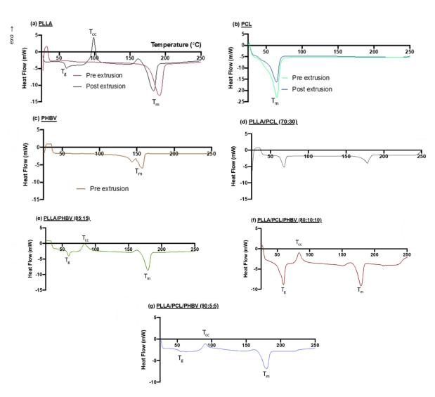
Figure 2. DSC curves (a) PLLA, (b) PCL, (c) PHBV, (d) PLLA/PCL (70:30), (e) PLLA/PHBV (85:15), (f) PLLA/PCL/PHBV (80:10:10) and (g) PLLA/PCL/PHBV (90:5:5).
