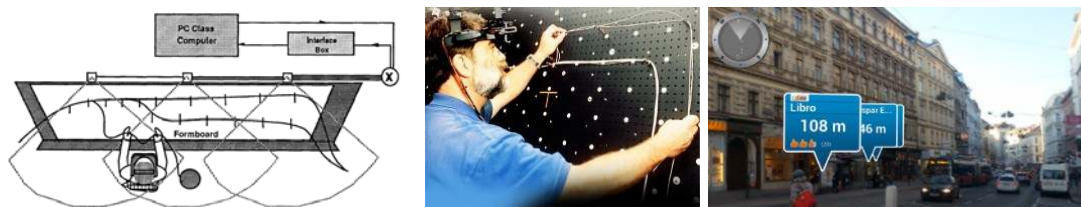
FIGURA 2.13 LA IMAGEN DE LA IZQUIERDA PRESENTE UN DIAGRAMA DE LA DISTRIBUCIÓN DE GENERADORES DE ONDAS ELECTROMAGNÉTICAS Y RECEPTORES DEL SISTEMA CONSTRUIDO POR CAUDELL [28]. LA FOTOGRAFÍA CENTRAL MUESTRA EL HMD DE CAUDELL SIENDO UTILIZADO PARA ENSAMBLAR CABLES[28]. LA IMAGEN DE LA DERECHA ES UN SCREENSHOT DE UNA APLICACIÓN LOCATION-BASED RA [190].
