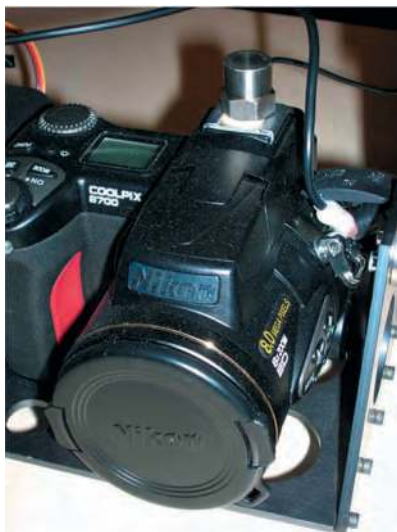
figure 21 Accéléromètre fixé sur le sabot du flash.
