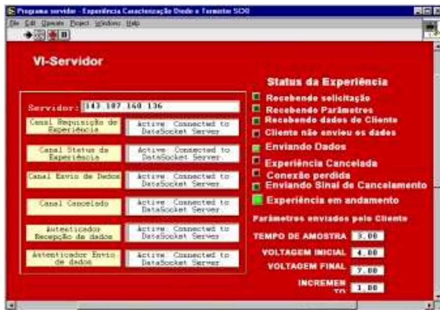
Figura 17 - Interface do VI-Servidor implementado em LabVIEW ® responsável pela comunicação entre o aparato experimental e o DataSocket Server ® .
