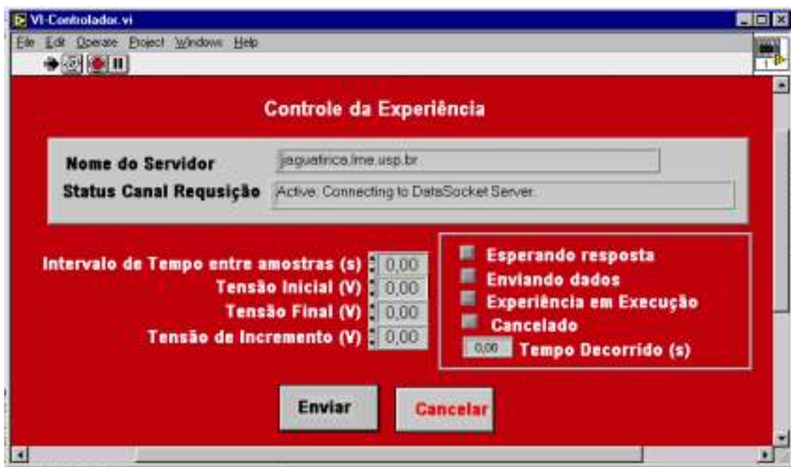
Figura 19 - Interface do VI-Controlador implementado em LabVIEW ® responsável por controlar a experiência de forma remota.
