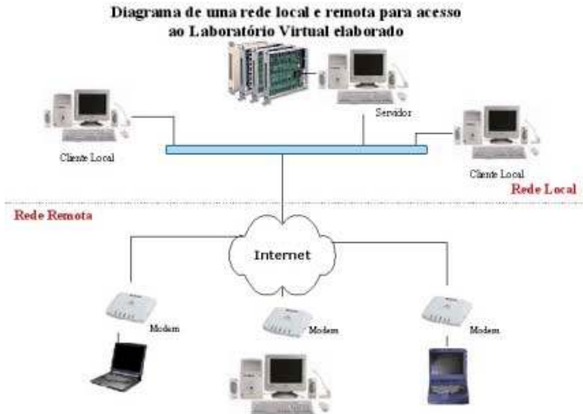
Figura 6 - Esquema de arquitetura de rede cliente/servidor para controle de instrumentos via rede de computadores.
