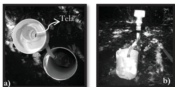
Figura 2 - Coletores utilizados para monitoramento de Pi a) vista superior e b) vista lateral
