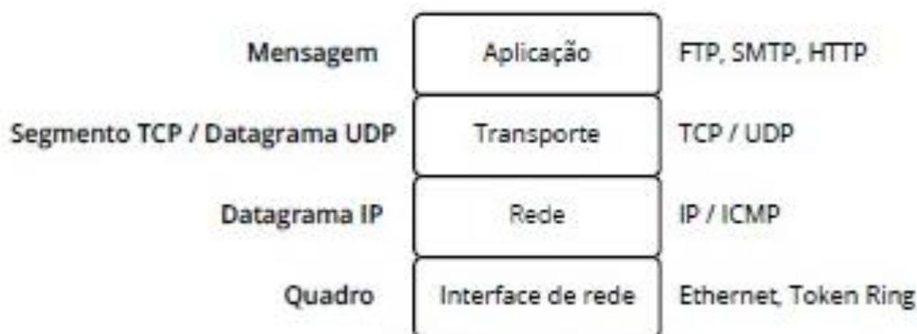
Figura 2.4 – Camadas de uma arquitetura baseada em TCP/IP
