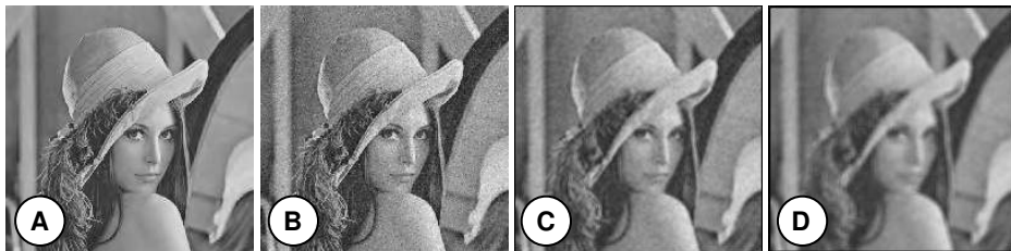
Fig. 20 – Filtro da média: (A) imagem original; (B) imagem ruidosa; (C) imagem filtrada com máscara 3x3; e (D) imagem filtrada com máscara 5x5.
