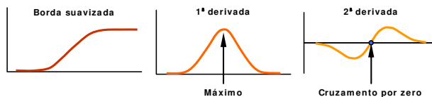
Fig. 22 – Verificação da existência de uma borda a partir do gradiente e do Laplaciano.
