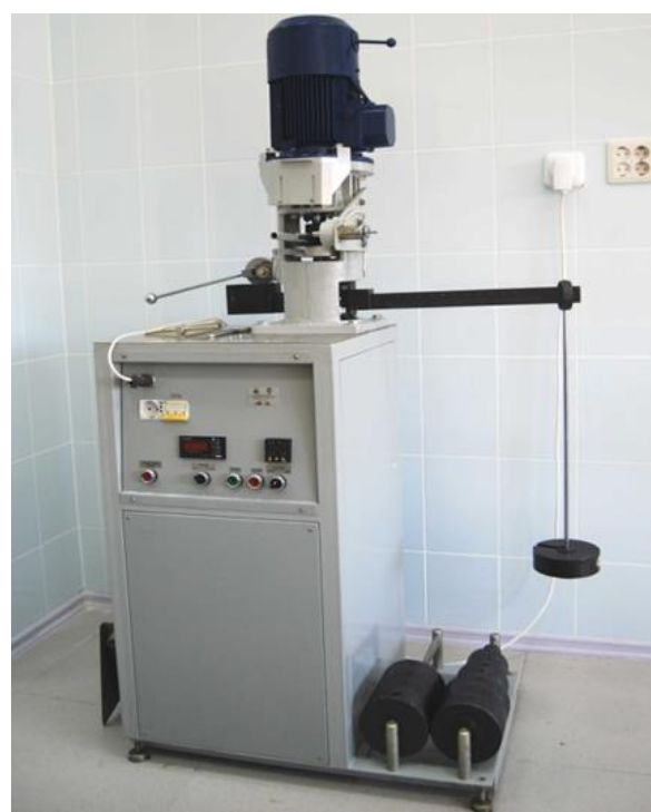
Fig. 3. The Four-ball machine.
