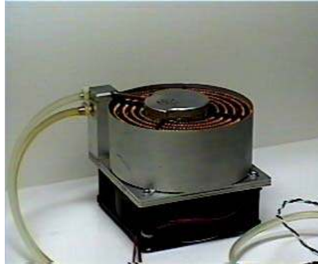
Fig. 3.2 24 Volt ISR Liquid Pump
