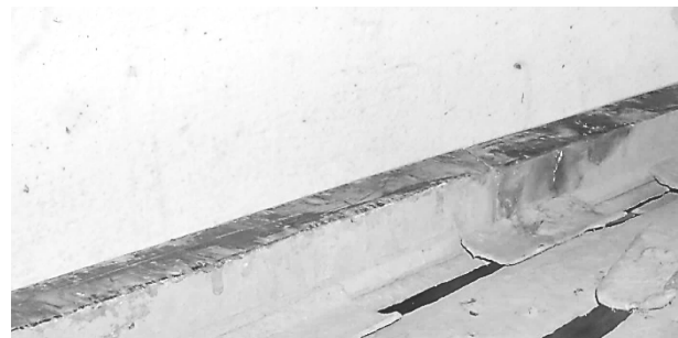
Рис. 3 Сліди міді на струмознімальній частині вставок
