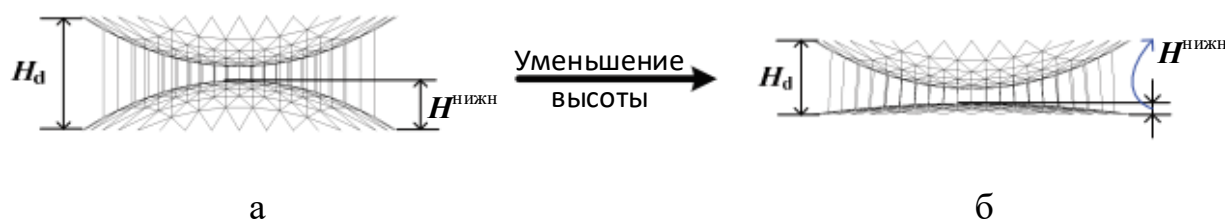
Рис. 6. Симметричная (а) и асимметричная (б) кабельные сети
