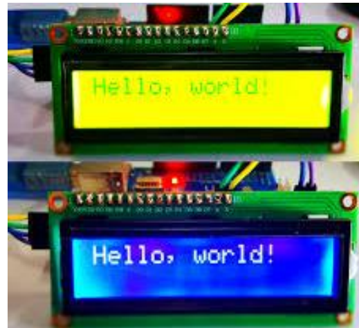
Gambar 5 Pengujian LCD 16x2
