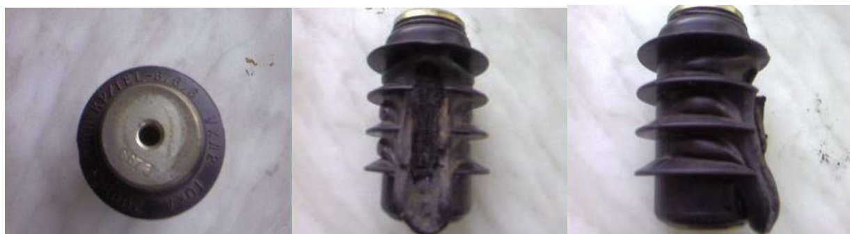
Рис. 6. Термическое разрушение ограничителя перенапряжений нелинейного в режиме дугового однофазного замыкания на землю
