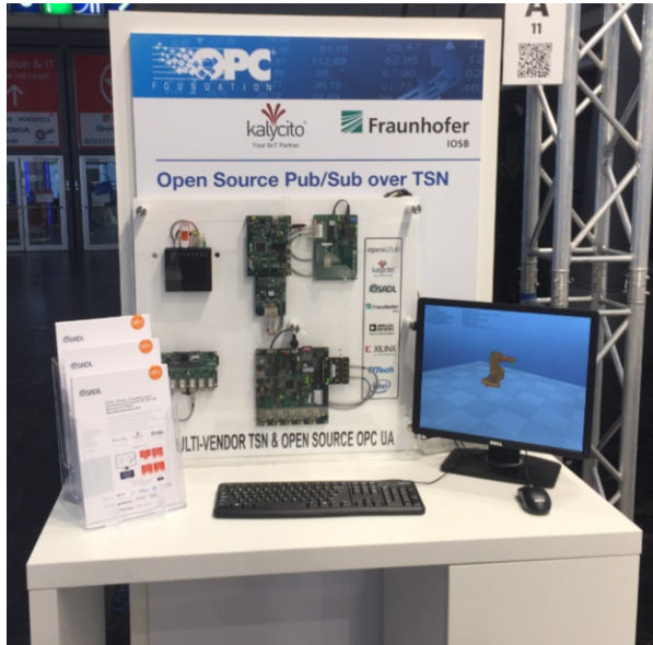
Abb. 2. OPC UA PubSub über TSN Demonstrator auf dem Stand der OPC Foundation auf der Hannover Messe 2018. Die folgenden Hardware-Plattformen wurden für den Demonstrator integriert: Intel Atom/i210 von TQ-Systems, Dual Chip Lösung mit ARM Cortex M4 + TSN Switch von Analog Devices, FPGA-TSN Cyclone V SoC von Intel PSG/Altera, Xilinx FPGA-TSN Zync SoC. Die Komponenten des Demonstrators verfügen über 2-Port Switches und sind zu einer Daisy Chain verbunden. Die verwendeten Betriebssysteme sind Linux mit der RT-Preempt Erweiterung [CB13] und FreeRTOS.
