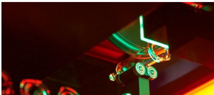
Abb. 4. Handhabungseinheit für die Inspektion einer Glasspritze. Unterhalb der Spritze befindet sich die Aushebeeinheit. Das Rad oberhalb des Prüflings versetzt diesen in Rotation.
