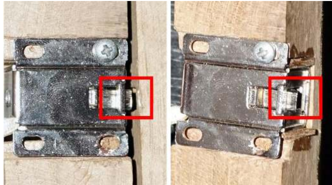
Gambar 6. Keadaan Solenoid Terbuka
