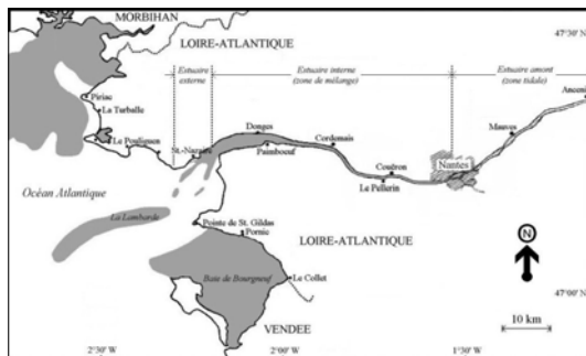
Figure 1 : Dépôts superficiels de vase devant les côtes de Loire-Atlantique et dans l'estuaire de la Loire (carte élaborée à partir de données publiées par LCHF (1987) et CMB Loire Estuaire (2003)).
