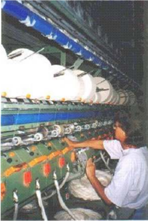
Figure 2. Représentation générale d'une section d'un métier à fibres libérées type Auto-2
