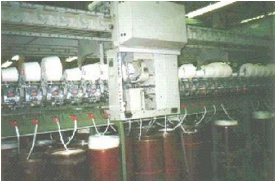
Figure 2. Représentation générale d'une section d'un métier à fibres libérées type Auto-2
