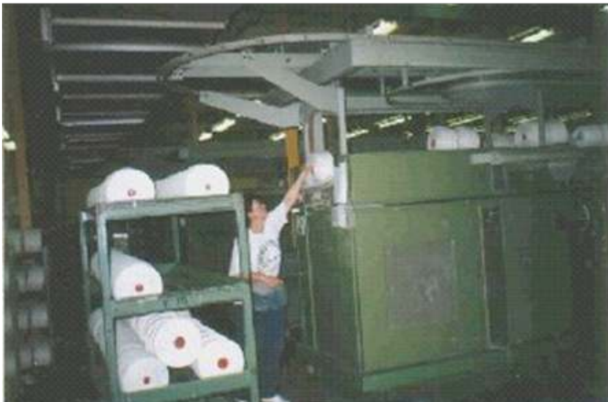
Figure 4. Transfert des cônes sur un chariot d'entreposage pour un métier à fibre libérées de type Auto-2
