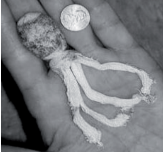
Figur 9.8. 23DS 12. Gauge, "Drag stabilized Bean bag". Projektillen utgörs av hagel inneslutna i en kevlarpåse. Den har en liten anslagsyta och vådaskott kan ge penetration. (Källa: FOI)
