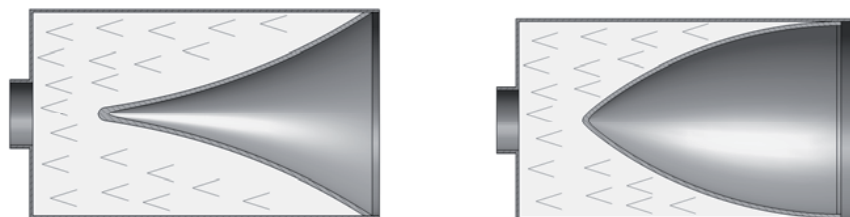
Figur 3.21. Trumpet resp. tulpanformat inlägg. (Källa: FOI)
