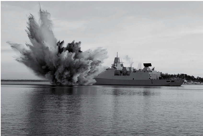
Figur 15.1. Sprängförsök mot den holländska fregatten Evertsen 2005 i samarbete mellan FOI och holländska marinen. (Källa: FOI)
