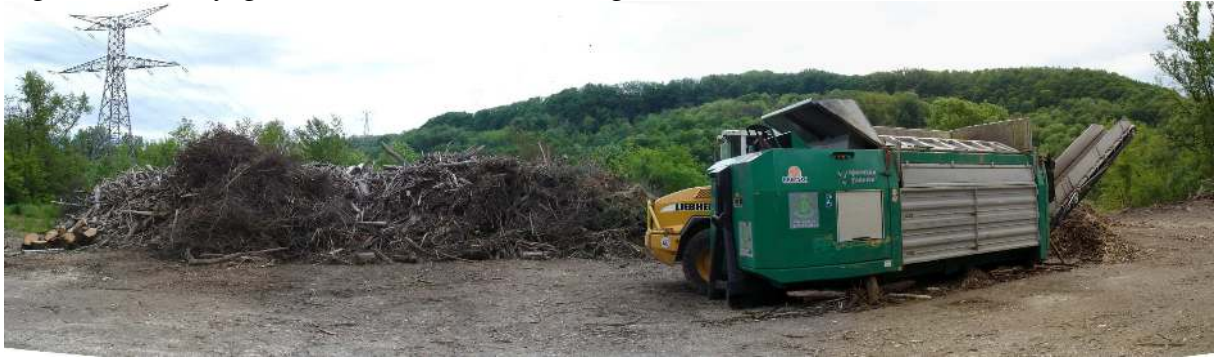
Figure 4. Le broyage des bois flottants au barrage de Génissiat (cliché : Moulin B., 2005).
