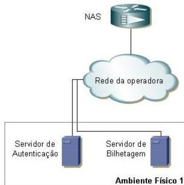
Figura 4.2: Segregação de funções de Autenticação e Bilhetagem
