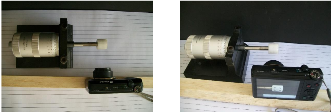
Figura 49 – Sistema de medição com micrômetro para testes estáticos
