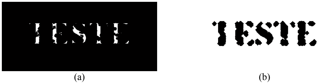
Figura 28 – (a) Erosão e (b) dilatação
