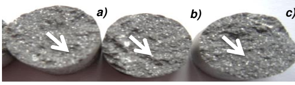
Şekil 9. Titreşim uygulamasına bağlı olarak kopma yüzey karakteristiğinin değişimi, a) 0, b) 50 ve c) 100 Hz (The change of crack surface characteristics depending on vibration applications; a) 0, b) 50 and c) 100 Hz)
