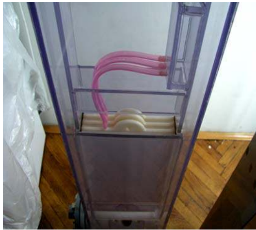
Fig. 7 Plate-and-frame immersed membrane module (Kubota, Japan)
